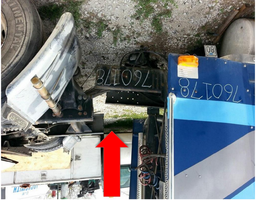
Figura 4. Foto de después, vehículo destruido (con rieles del bastidor cortados)
